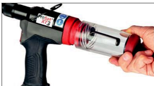
Szybko odłączany układ kolektora trzpieni (MCS)
